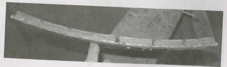
Immagine degli sportelli dove sono state praticate le fresature lungo la venatura per snervare le fibre del legno e poter raddrizzare il pannello
